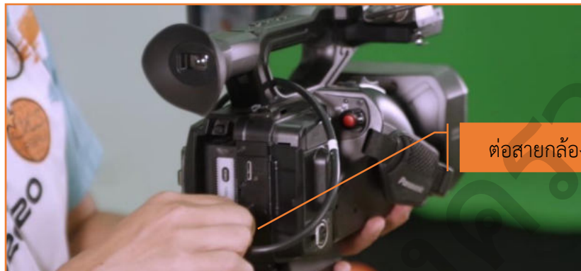
ภาพที่ 3.17 การต่อสายกล้อง
