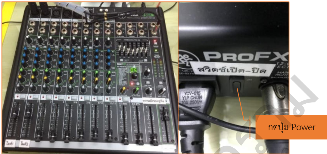
ภาพที่ 3.41 การเปิดเครื่อง Mixing กดปุ่ม Power
